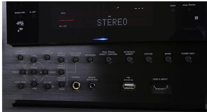
Bedienelemente und Anschlüsse (USB, HDMI, Kopfhörer, Mikrophon) unter Klappe
