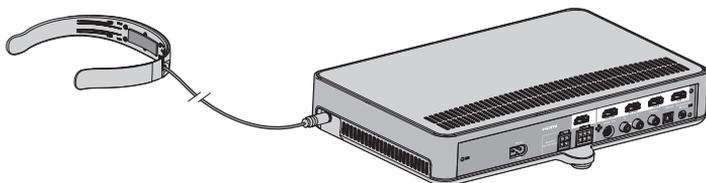
2. Schließen Sie das Kabel des ADAPTiQ-Headsets an den Anschluss
