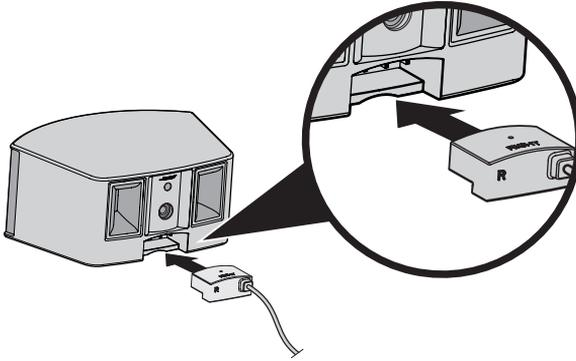
2. Schließen Sie den anderen Stecker des Kabels für den rechten Lautsprecher an den 4-poligen Anschluss **Speaker Connections** an der Konsole an.
