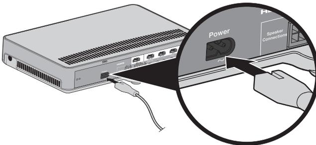
2. Schließen Sie das Netzkabel an eine Steckdose an.
