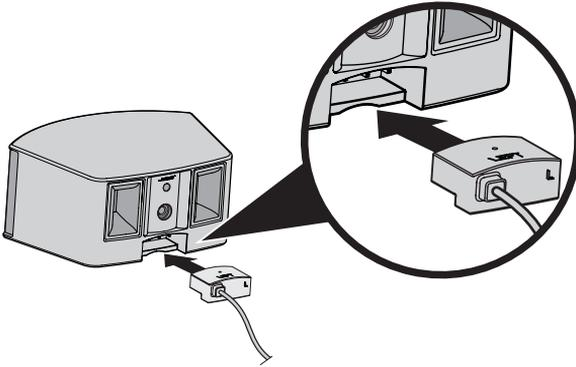
2. Schließen Sie den anderen Stecker des Kabels für den linken Lautsprecher an den 6-poligen Anschluss **Speaker Connections** an der Konsole an.
