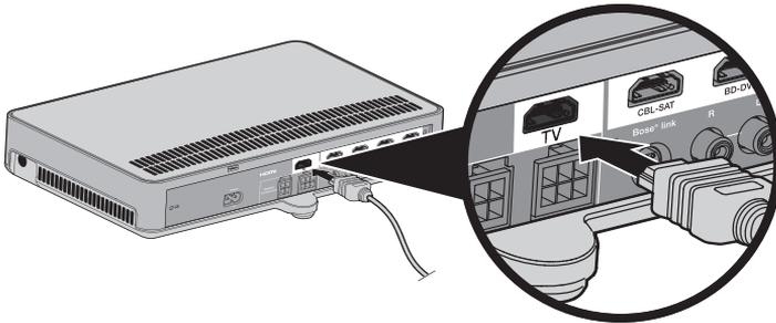
3. Schließen Sie das andere Ende des HDMI-Kabels an den **HDMI**-Anschluss des Fernsehgeräts an.
