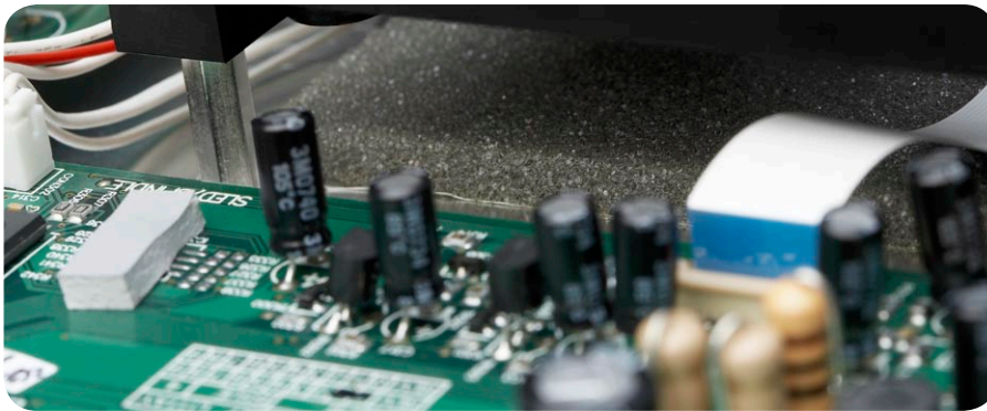
Unterhalb der Laufwerksbasis befindet sich eine Schaumstoffmatte, die ebenfalls Teil des umfassenden Resonanztuning-Konzeptes ist. Links ist eins der zahlreichen Sorbothan-Pads zu erkennen
